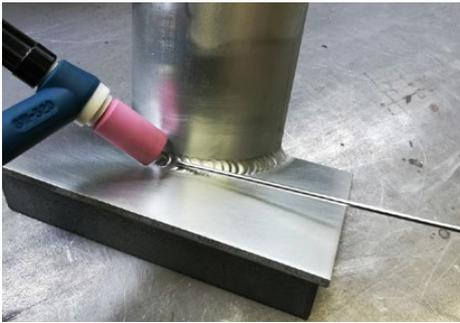
Les impulsions basses fréquences sont utilisées lorsqu'une finition esthétique de la soudure est nécessaire.
