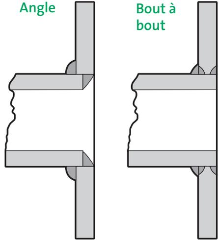
Lors de la soudure de bride, pour une question de facilité et de productivité, l'axe du tube doit être vertical et la bride en rotation.
