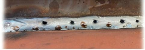
Pour éviter les porosités, les paramètres de soudage sélectionnés qui génèrent une fluidité dans le bain de fusion doivent être suffisants afin que les gaz ne soient pas enfermés.
