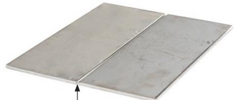
Pour tous les types de joints, utilisez la même technique en poussant la torche. Le fil doit être dirigé au centre du joint et votre posture doit être ajustée de façon à ce que l'arc soit concentré dans le bain de fusion plutôt que vers l'extérieur. Cela réduira également le risque de brûlure.
