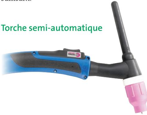
Une torche avec diffuseur de gaz fournit un débit de gaz laminaire permettant de régler l'électrode plus loin à partir de la fin de la buse afin d'améliorer la visibilité de l'arc et du bain de fusion tout en maintenant un bon niveau de protection.
