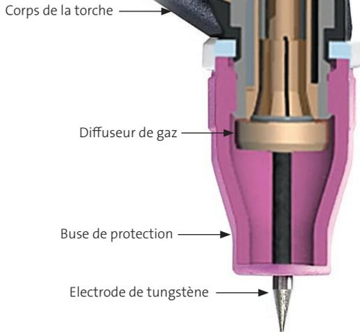
Les gaz de soudage d'Air Products sont conçus pour offrir des performances optimales lors du soudage TIG. Tous ces gaz répondent aux exigences de la norme ISO14175 / AWS 5.32 - "Produits consommables pour le soudage - Gaz et mélanges gazeux pour le soudage par fusion et les techniques connexes."
