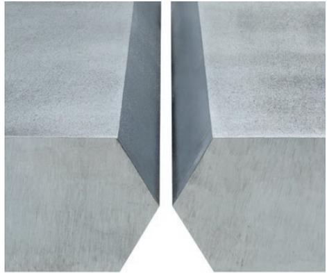
Les recommandations pour la préparation de la soudure de l'aluminium et de ses alliages peuvent être référencées dans l'ISO 9692-3 "Soudage et techniques connexes — Types de préparation des joints — Partie 3 : soudage TIG et MIG de l'aluminium et de ses alliages."
