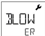
Dès que l'intervalle de maintenance de l'appareil est atteint, "BLOWER" ou "DRIVE" apparaît après l'affichage de démarrage. L'affichage disparaît automatiquement après 10 sec. ou peut être confirmé par un appui sur le bouton de *confirmation* (40). L'appareil doit impérativement être porté au centre de service.
