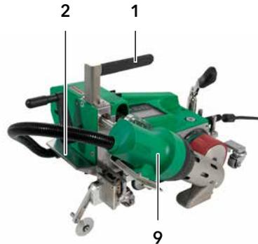
Faites pivoter la **soufflerie à air chaud (9)** vers l'intérieur avant le transport. Pour soulever la soudeuse automatique à air chaud à la main, utilisez la **poignée de transport (1)** ou les **poignées (2)** sur le boîtier en aluminium.
