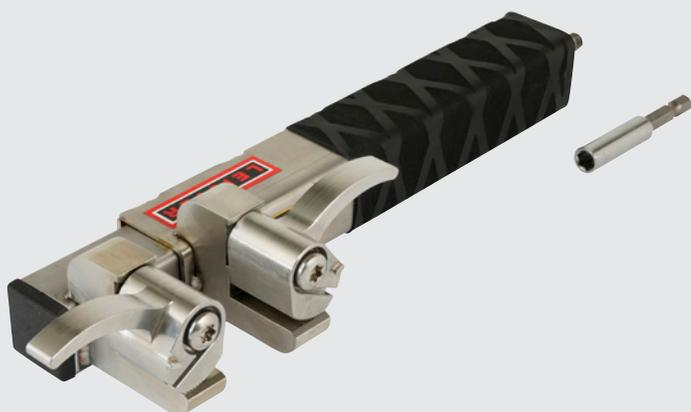
Le testeur de traction EXAMO 100 teste la qualité du cordon de soudure des géomembranes. Avantages: serrage sans outil des échantillons, vitesse de traction constante ainsi que traction sans effort des échantillons à l'aide du tournevis sans fil.
