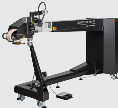
La machine à souder SEAMTEK W-2000 AT offre aux utilisateurs encore plus d'espace que la SEAMTEK W-900 AT. Cela permet de souder efficacement et en toute sécurité de grands produits fabriqués à partir de textiles techniques.
