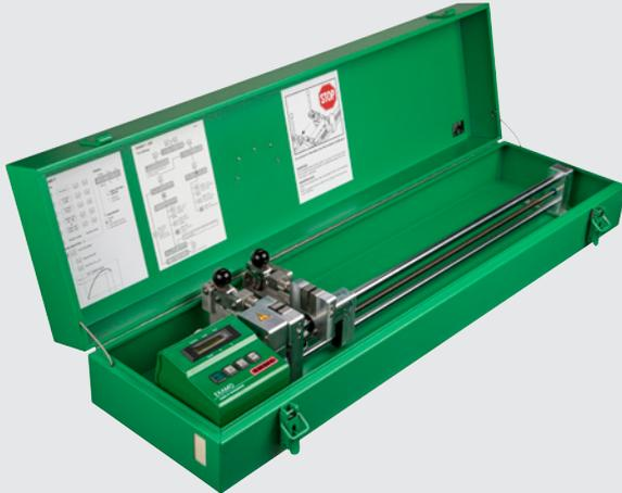
L'EXAMO 600F USB est l'appareil de test idéal pour vérifier le cordon de soudure de membranes hautement élastiques en ce qui concerne leur adhérence au pelage, leur résistance à la traction et au cisaillement. Testé et éprouvé dans le monde entier.
