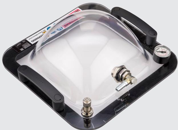
VACUUM BELL est une cloche à vide pratique en plastique. Il est surtout utilisé dans le génie des décharges et la construction de tunnels pour assurer l'étanchéité des soudures par chevauchement.
