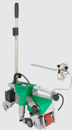
La soudeuse de sol automatique, UNIFLOOR 500, convient pour souder les revêtements de sol souples en plastique et les sols antistatiques ESD, ainsi que les revêtements naturels en linoléum et en caoutchouc.
