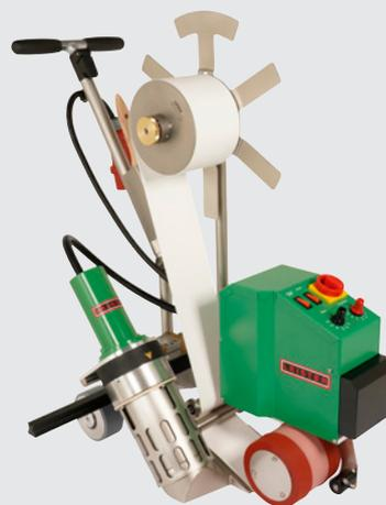
La machine à souder TAPEMAT SPRIEGEL permet de souder rapidement et économiquement des rubans de renfort sur les bâches de camion et les tissus industriels.
